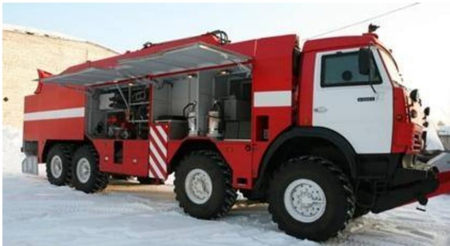
Рис. 4. Автомобиль пожарно-спасательный бронированный АПСБ-6,0-40-10 на базе КАМАЗ-63501
